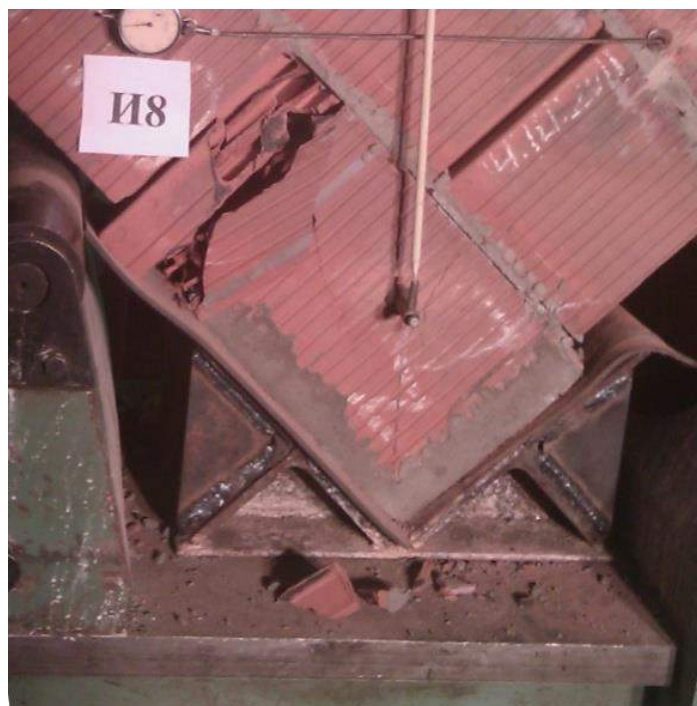
Рисунок 2.31 – Разрушение опорной зоны образца С3-250
