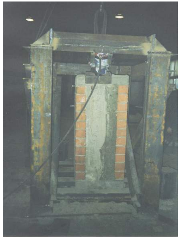
Рисунок 2.4 – Образец 4-х слойной стены на испытательном стенде
