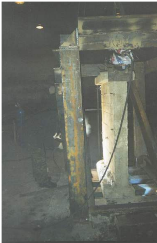
Рисунок 2.3 – Образец однослойной стены на испытательном стенде
