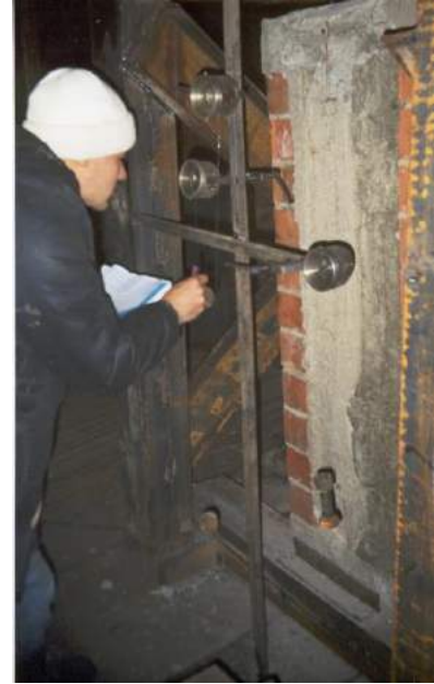
Рисунок 2.6 – Установка прогибомеров при испытании многослойных фрагментов
