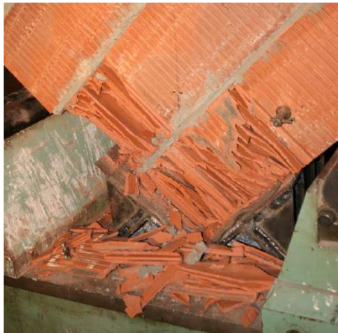
Рисунок 2.30 – Разрушение опорной зоны образца C2-250
