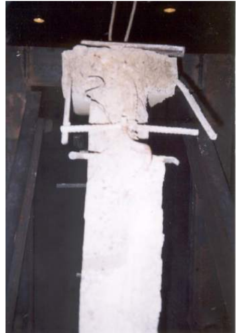
Рисунок 2.16 – Повреждения упорной части при одностороннем нагружении однослойного фрагмента
