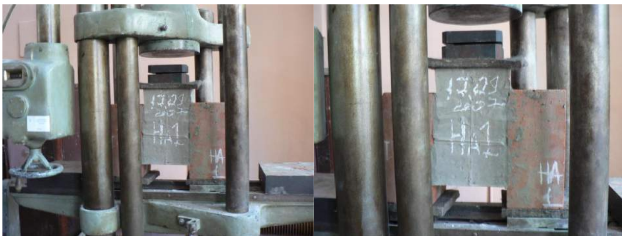
Рисунок 2.62 – Фрагмент для испытаний межслоевого касательного сцепления кирпичных и железобетонного слоев перед испытаниями
