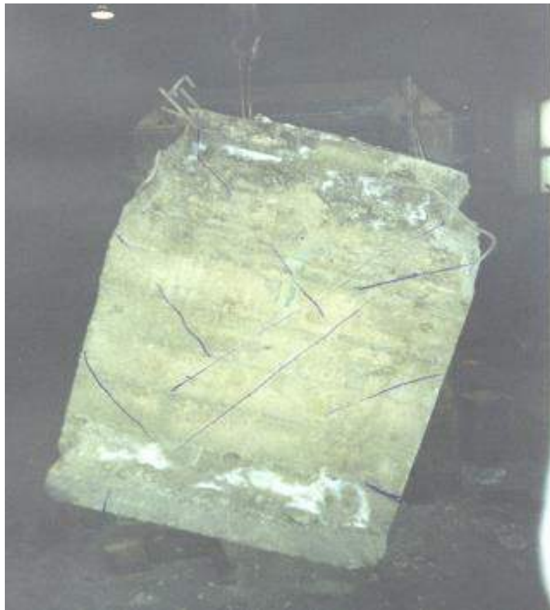
Рисунок 2.7 – Однослойный фрагмент стены после испытаний
