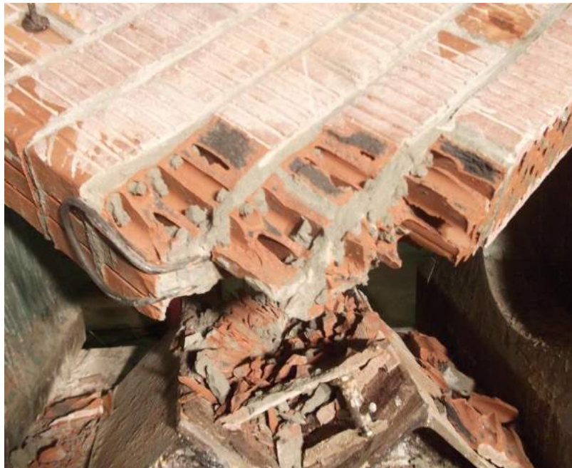
Рисунок 2.24 – Образец С2-1 после снятия с испытательной установки
