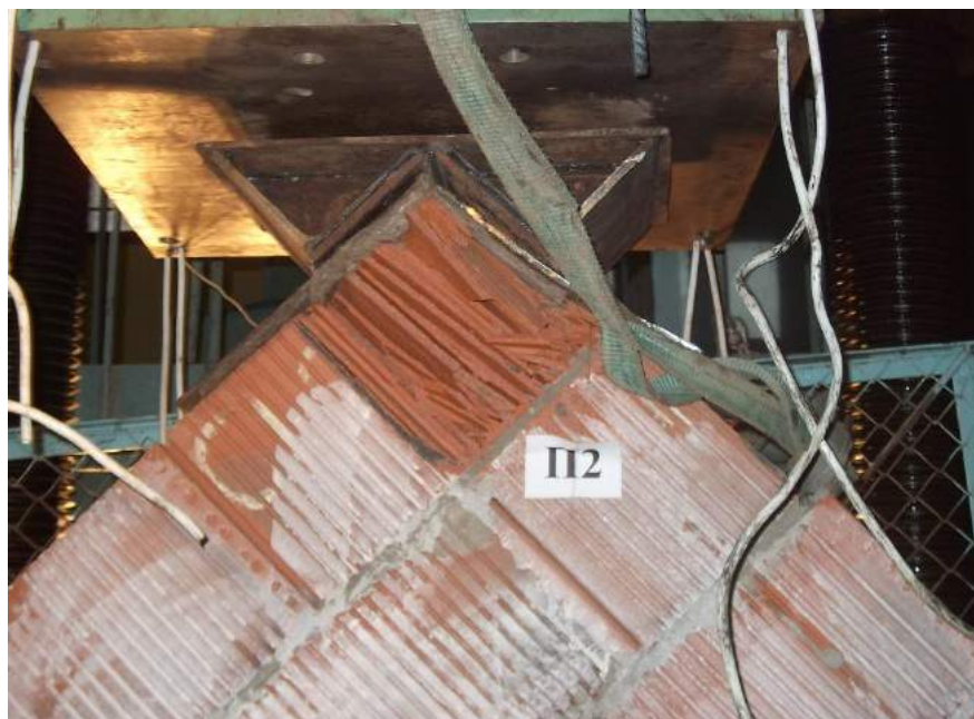
Рисунок 2.28 – Разрушение образца С1-250
