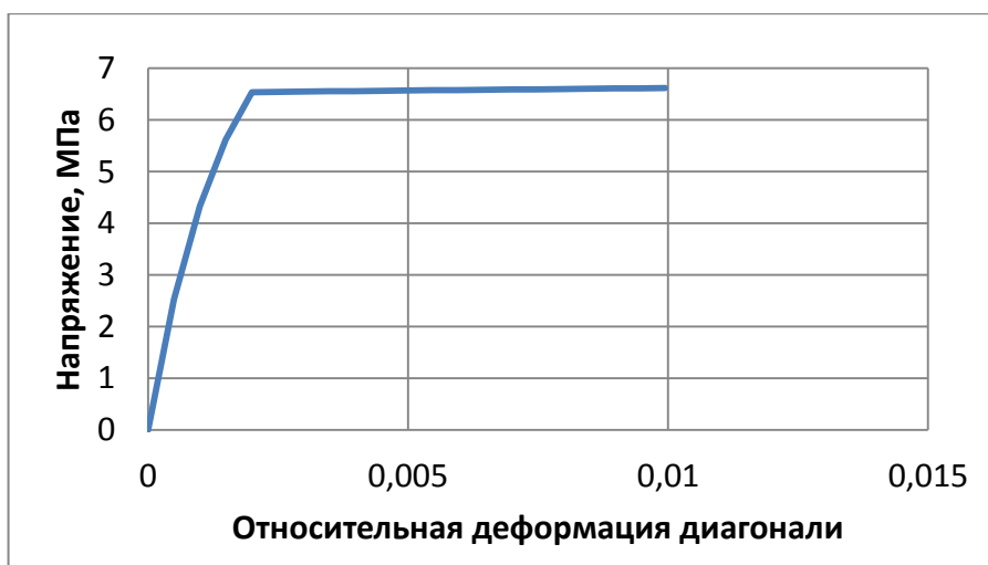
Рисунок 4.10 – Исходная диаграмма «напряжение-относительная деформация диагонали» для кирпичной кладки с расчетным сопротивлением R=3,9 МПа
